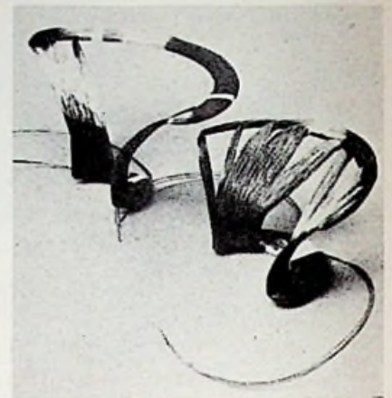
Afb. 5 Één helft van de raster- en één helft van de lijnafbuigwikkeling.
