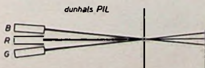
Fig. 1 Het verschil waarmee de buitenste kanonnen bij 'dikhals' en 'dunhals' naar binnen neigen, overduidelijk voorgesteld. (bovenaanzicht)
